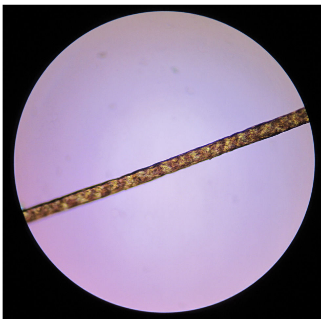
Figura 1 Bandas transversales claras y oscuras alternantes (patrón «en cola de tigre») en el examen con microscopio óptico con luz polarizada.
