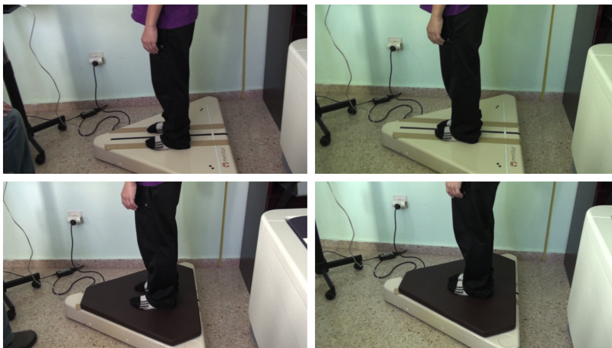
Figura 2 Análisis del equilibrio estático con los pies separados y pies juntos sin foam; y pies separados y pies juntos con foam en la plataforma de fuerza Metitur Good Balance .
