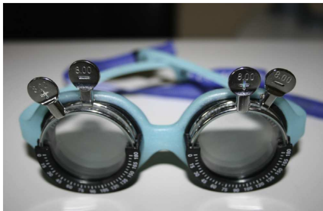
Figura 1 Prueba de confusión con lentes. Se trata de miopizar al paciente con una lente de alta potencia y posteriormente neutralizarla con los valores positivos.
