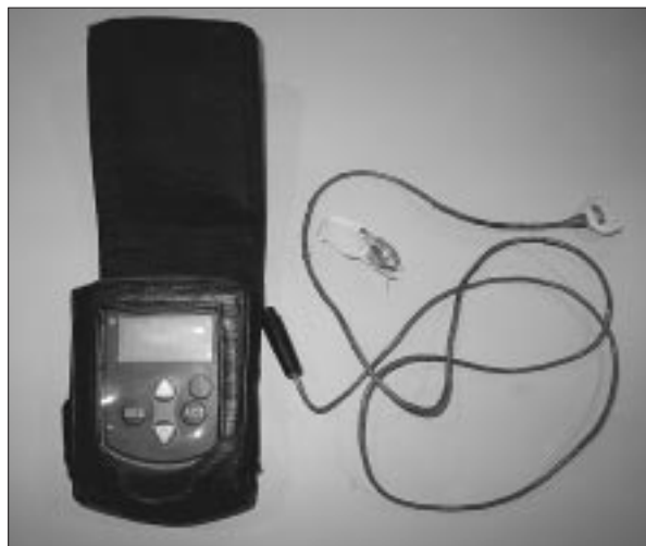
Figura 1. Equipo de registro (sensor, cable y registrador) de la monitorización continua de glucosa subcutánea Minimed ® .
